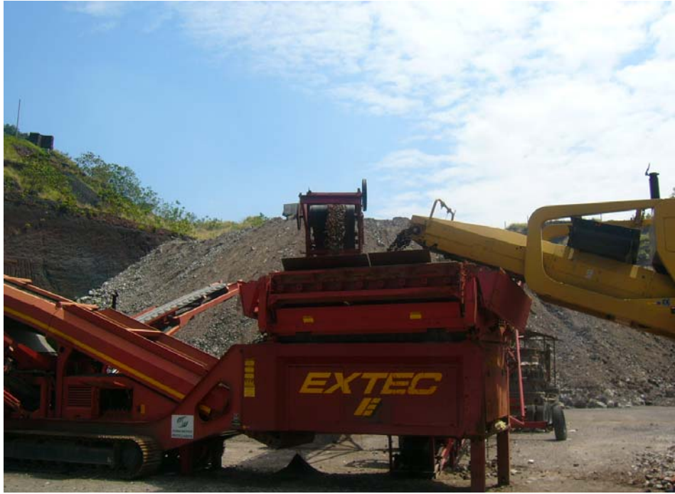
Figura 5.2 Planta de Clasificación de Doble Criba. Concretos Reciclados S.A. de C.V. 2006
