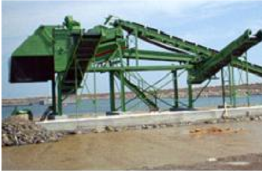
Figura 5.9 Unidad de Separación por Aire Fuente: Recovery S.A. 2006
