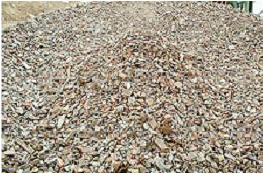
Figura 5.12 Material con Granulometría 22-44 mm. Fuente: Recovery S.A. 2006
