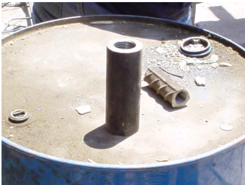
Foto 13. Coples de unión para varillas del # 12 y # 8.
