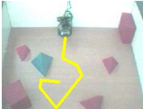
Figura. 6.10 Trayectoria parcial del robot usando el algoritmo de Braitenberg modificado y visión
