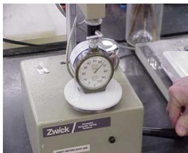
Figura 6.6. Durómetro *Shore* tipo A
