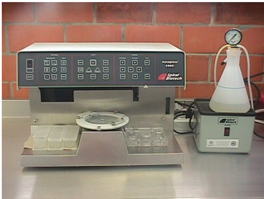
Figura 2.3.1. Sembrador en espiral Autoplate 4000, Spiral Biotech, EUA.
