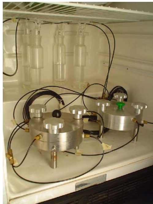
Figura 6.10. Sistema usado para determinar la permeabilidad a los gases de las películas estudiadas.
