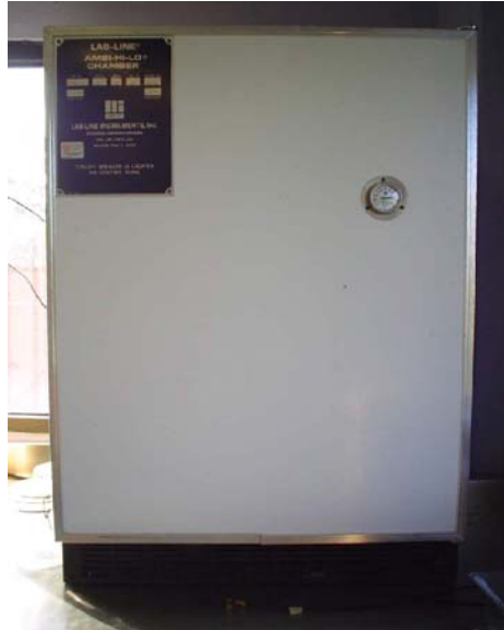
Figura 6.7. Cámara de temperatura controlada
