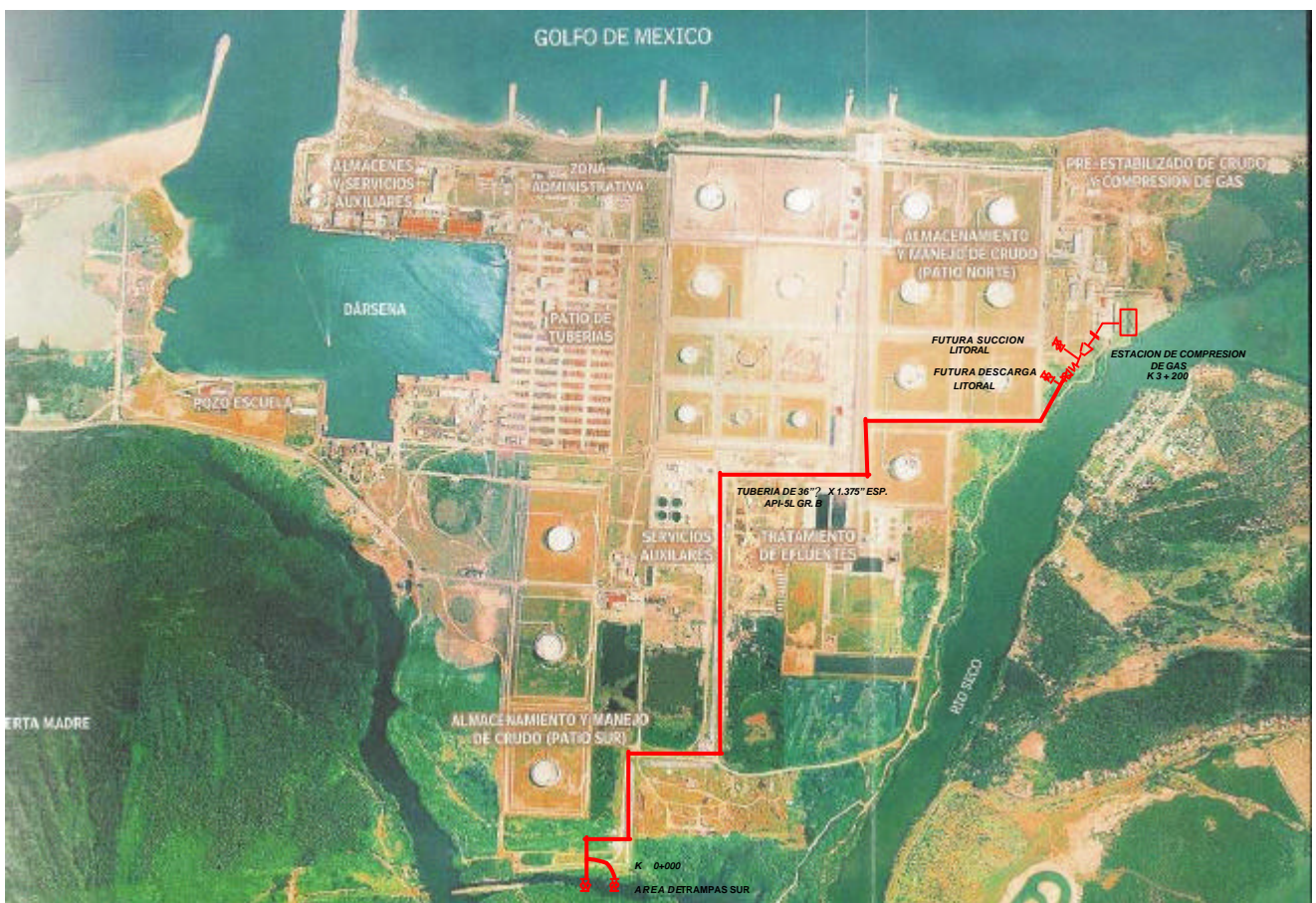
Figura no. 2. Trayectoria del gasoducto de 36” \varnothing x 3.2 km. en la parte interna de la TMDB (tramo 1A).
