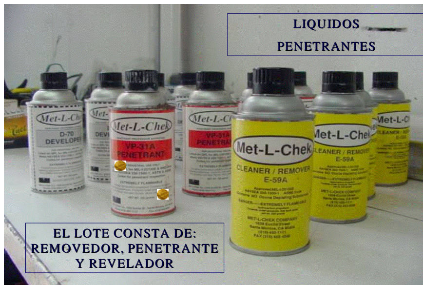
FIGURA No. 96 LÍQUIDOS PENETRANTES PARA DETECTAR DAÑOS SUPERFICIALES.
