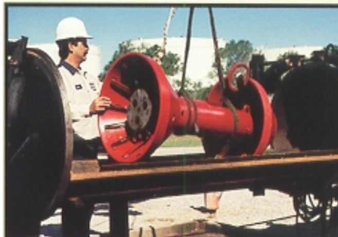
FIGURA No. 72 DIABLO CALIBRADOR ELECTROMECHANICO
