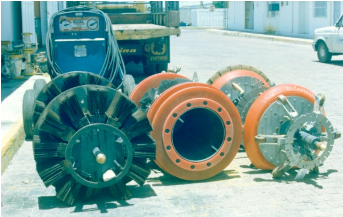
FIGURA No. 84 DOS DIABLOS DE LIMPIEZA Y UN TIPO DUMMY PARA CORRERSE EN UN GASODUCTO DE 36"Ø
