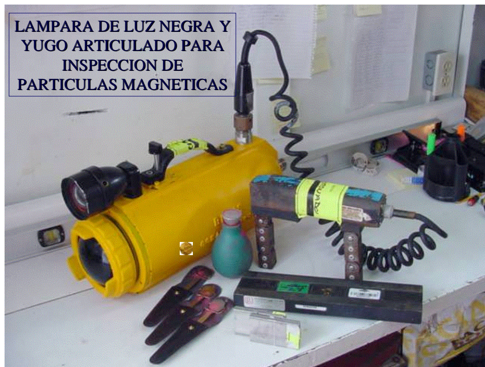
FIGURA No. 51 EQUIPO DE PARTÍCULA MAGNÉTICAS SUBMARINO.
