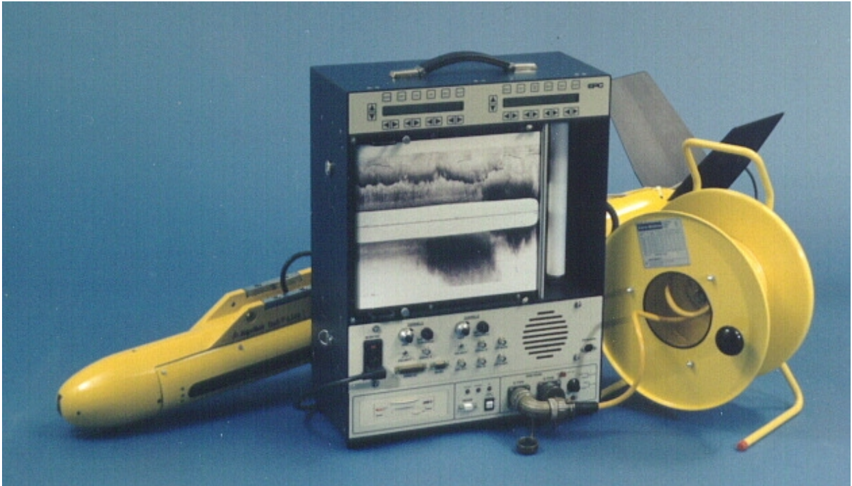
FIGURA No. 40 SISTEMA SONAR DE BARRIDO LATERAL
