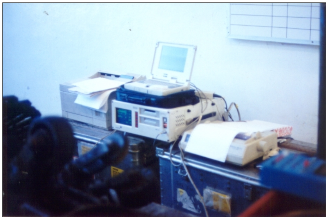
FIGURA No. 78 EQUIPO DE CAMPO PARA REVISIÓN DE LOS REGISTROS OBTENIDOS AL HABER EFECTUADO UNA CORRIDA DE DIABLO INSTRUMENTADO PARA DETERMINAR SI LA CORRIDA FUE BUENA Ó NO
