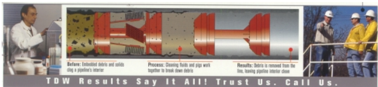
FIGURA No. 69 LIMPIEZA INTERIOR DE UN DUCTO EMPLEANDO DIABLOS DE COPAS Y CEPILLOS
