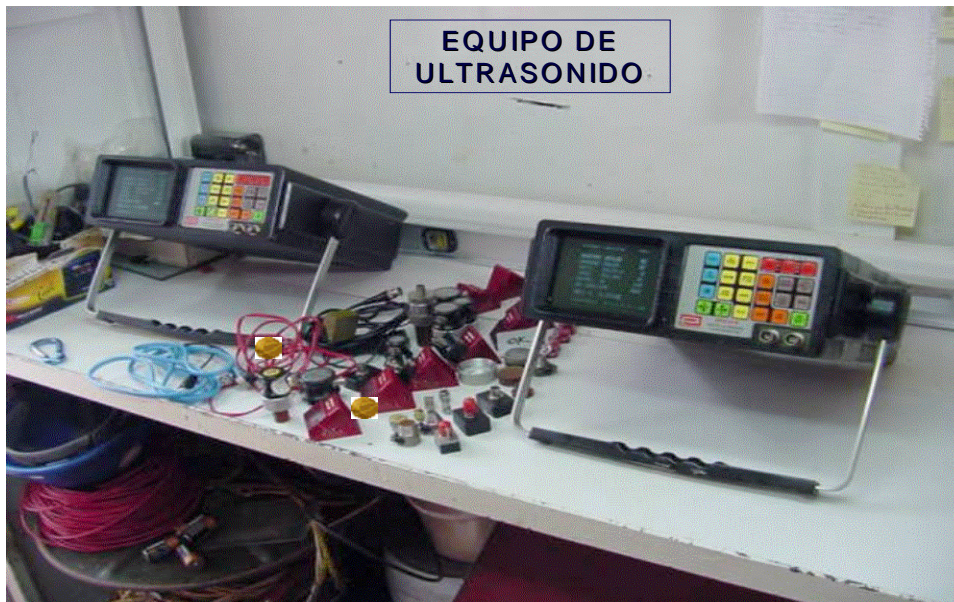
FIGURA No. 95 EQUIPO DE ULTRASONIDO PARA TOMA DE ESPESORES Y DETECCIÓN DE FALLAS.
